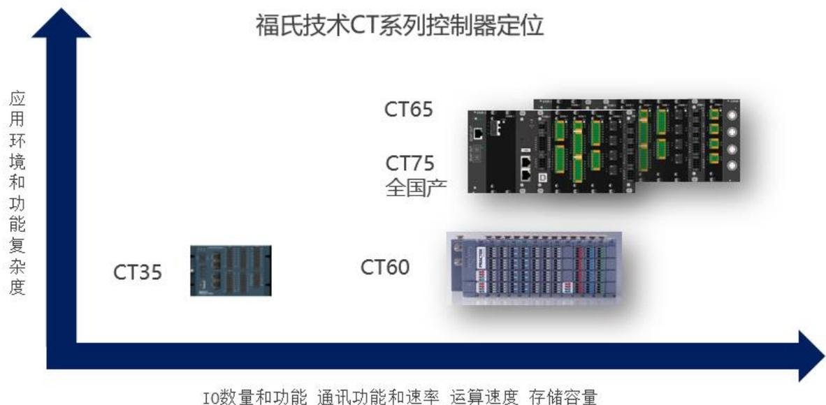
CT75 可编程控制器采用 100%国产元器件，面向环境要求、振动 EMS 防护要求较高、系统功能较复杂、安装空间较小的客户使用需求。具有百兆级高速背板总线，同时支持 EtherCAT 和 PROFINET 接口，模块化设计、功能可扩展，拥有国家权威机构发布的全国产化认证报告。搭配自主研发的 FS OS 操作系统，使控制平台具备高安全性、高实时性、高可靠性以及支持智能化的特性。支持 Profinet、EtherCAT、Ethernet、TSN OPCUA、Modbus TCP/IP、Modbus RTU、OPC UA、SFTP、SCP、Https、Profibus DP、CANbus、CANopen、RS485、RS422 等多种网络通讯和总线协议。支持基于 IEC61131-3 标准的 PLC 语言和 C 语言、Python 等多种语言编程。
